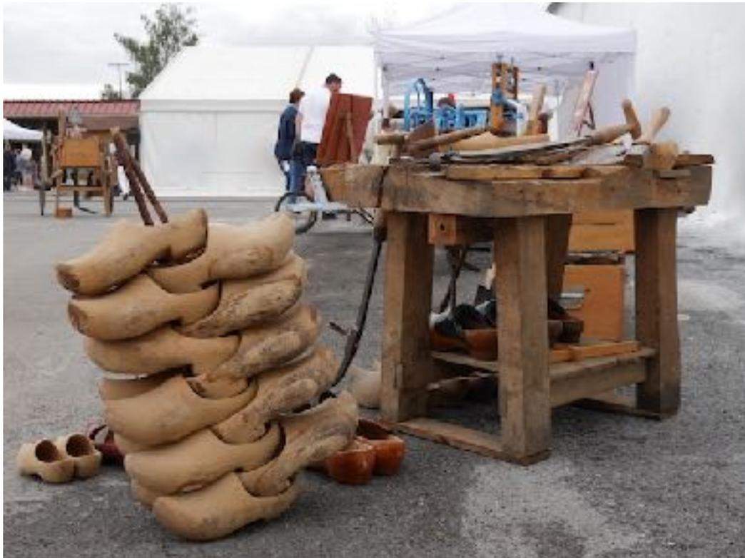
**Le sabotier** creuse ensuite le sabot sur le banc à creuser qui permet de bloquer le sabot pour le travailler. La tarière, sorte de vrille de 40 cm, est alors utilisée puis la cuiller (ou cuillère), outil tranchant en forme de cuillère. Le creusage est finalisé à l'aide du bouterolle et de la ruine.
